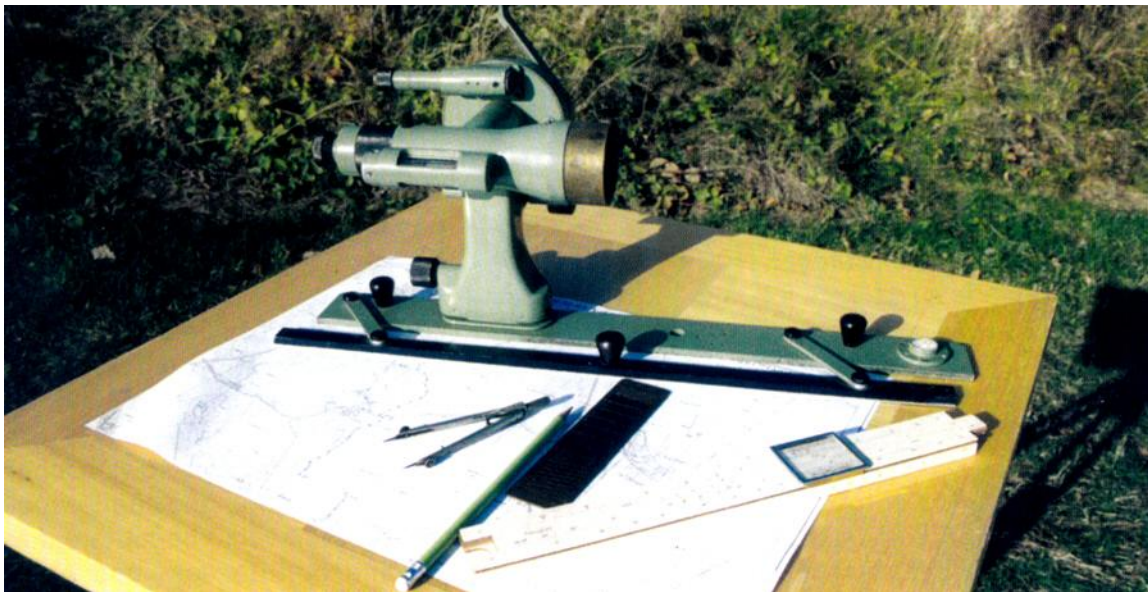
Abb. 39. Messtisch mit Kippregel.
