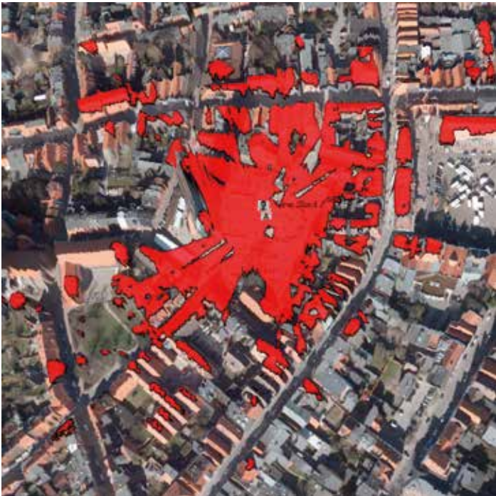
Obige Abbildung zeigt eine Sichtbarkeitskarte für die Innenstadt der Hansestadt Wismar (Standpunkthöhe 10 m); Hintergrundabbildung: Mit Digitalem Orthophoto texturiertes Digitales Oberflächenmodell
