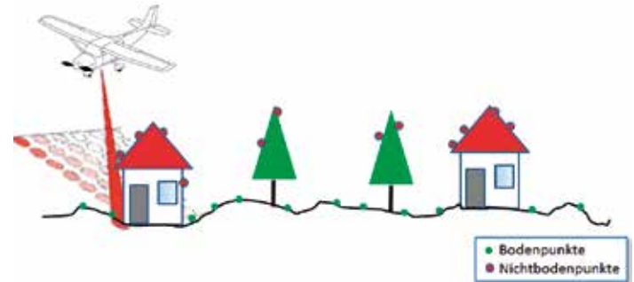
Prinzipskizze Airborne Laserscanning
