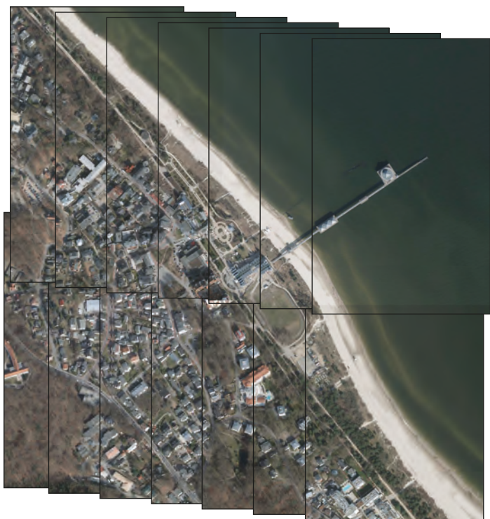
Bildflug Usedom 2018 - Beispiel für 80 % Längs- und 30 % Querüberdeckung
