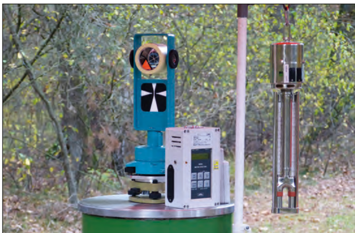
Bild 6: Zieltafel mit Reflektor auf einem Messpfeiler mit Geräten zur Erfassung der äußeren Bedingungen
