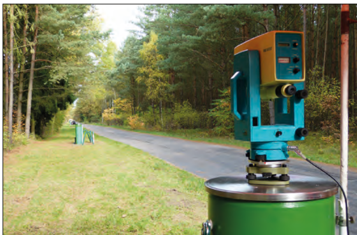
Bild 5: Sollstreckenbestimmung mit dem Mekometer ME 5000
