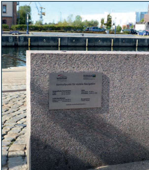
Kontrollpunkt mit Hinweistafel
