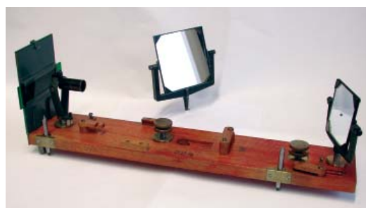
Abb. 9: Bertramsches Heliotrop, nach Anordnung der trigonometrischen Abteilung der Preußischen Landesaufnahme (ca. 1923)
