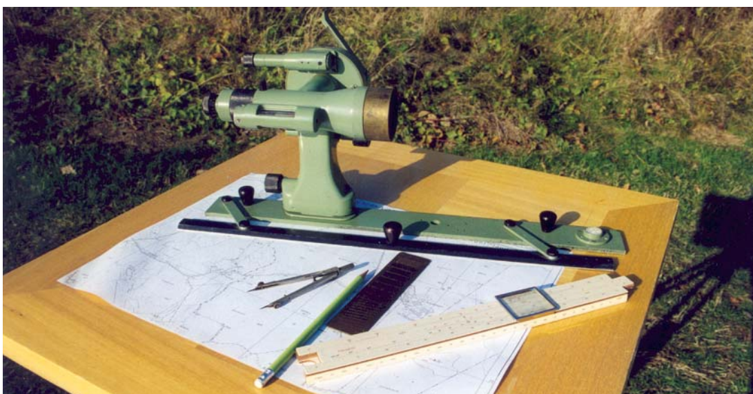
Abb. 6: Topographische Aufnahmetechnik, Messtisch und Kippregel
