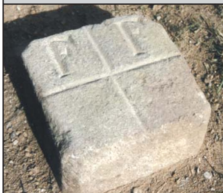
TP (Meckl.) Steinpfeiler bis 35 cm x 35 cm (auch mit Keramikbolzen)*
